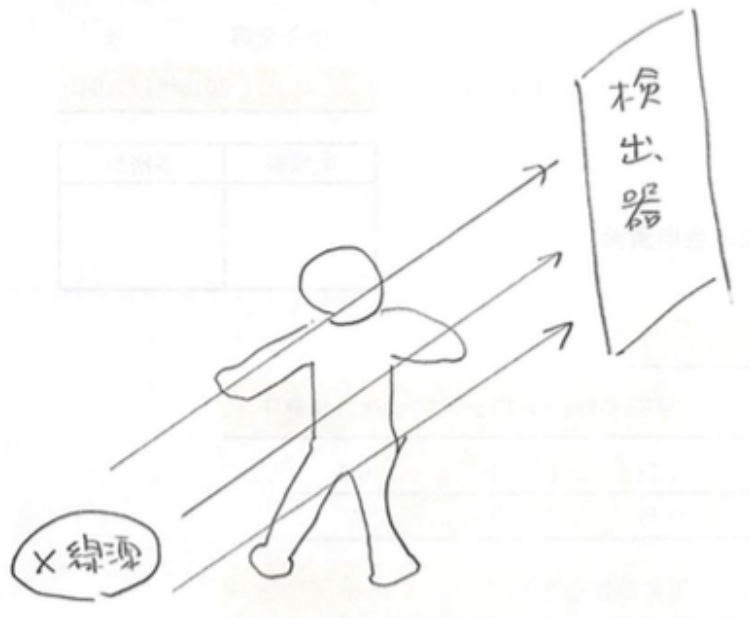
図 10.1: X線源から発せられたX線は人体を透過するとき減衰して検出される
