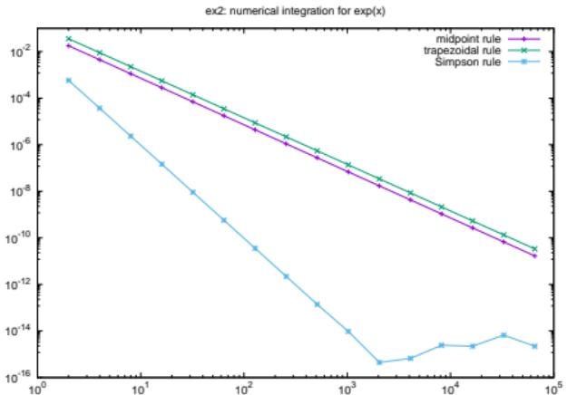
Figure: 横軸は  $N = 2, 4, \dots, 2^{16} = 65536$ , 縦軸は誤差 (両軸とも対数目盛)
